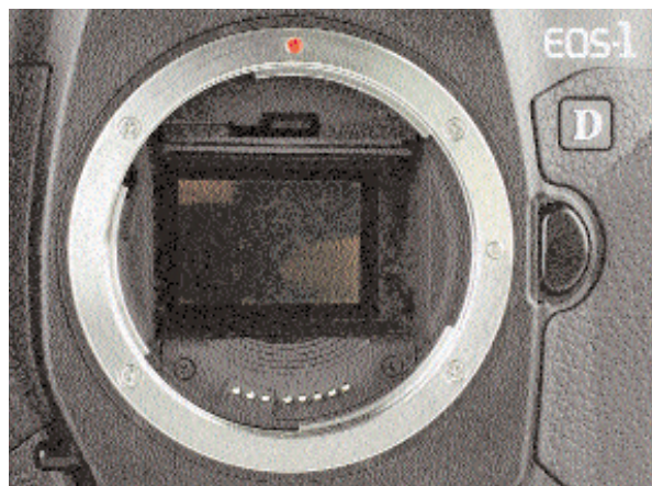
L'obiettivo, come sempre in fotografia, deve essere pulito. Bisogna fare attenzione anche a proteggere la macchina da ogni eccesso di polvere: soprattutto sulle fotocamere reflex un rischio sempre presente è che qualche granello entri quando si cambiano gli obiettivi e si appoggia sul sensore. Qui si vede il sensore di una reflex ammiraglia, la Canon EOS 1D, da 4 Megapixel.
